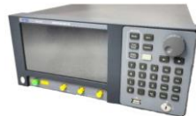
1550nm High speed Ps laser (Pulse & CW)
