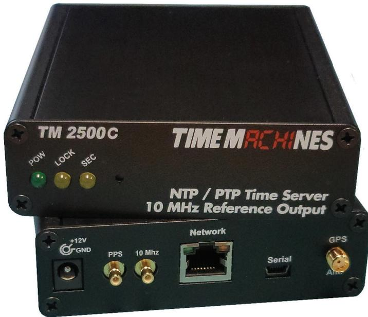
TM2500Cでは、TM2000Bの実績ある精度と信頼性を受け継ぎ、OCXO出力の高度な測定と処理により、ホールドオーバー機能の精度を大幅に向上されています。また、1PPSと10MHz信号出力用SMBコネクタが装備されています。さらに、10MHz出力はGPS 1 PPS信号と同期できるようになっています。
