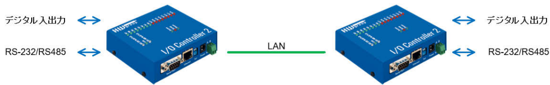
Box-2-Boxモード構成例 (1:1接続)
